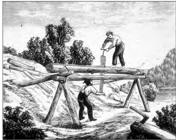
Handsagskjerjing kunne gjerast overalt ettersom det ikkje var nødvendig med vasskraft. (Romsdalsmuseets fotoarkiv)
